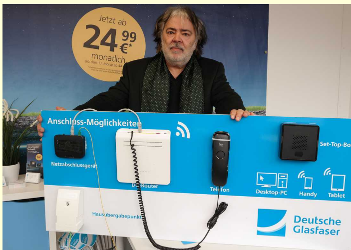
Andreas Gruß zeigt im Servicepunkt Aßling an einer Demowand die Anschlusskomponenten eines typischen Glasfaseranschlusses. Links-unten sieht man den Hausübergabepunkt und darüber das Glasfaser-Netzabschlussgerät für die Wohnung. Rechts daneben sind der Internet-Router von Deutsche Glasfaser und ein Telefon zu sehen und schließlich die optional erhältliche DGTV-Set-Top-Box fürs Internetfernsehen.
